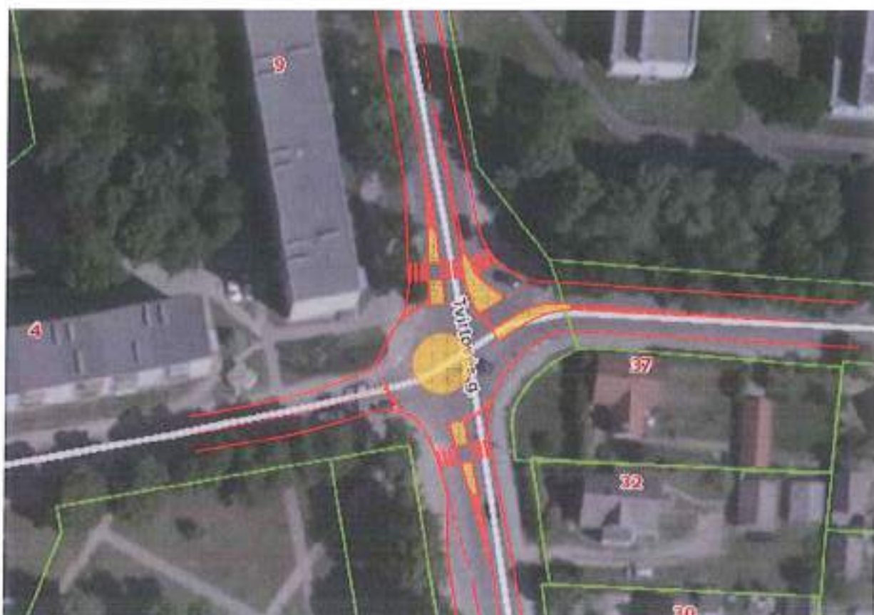
9 pav. Pasiūlytas Tvirtovės – Ligoninės – Žiburio gatvių sankryžos pertvarkymo sprendinys į mini žiedinę sankryžą ( D_{\text{ker}}=20 m, žiedinė važiuojamoji dalis 5 m).
